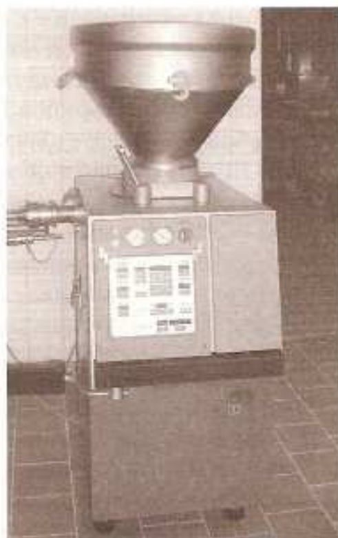
Рис. 33. Шнековый шприц-наполнитель VF-50 фирмы «Handtmann»
