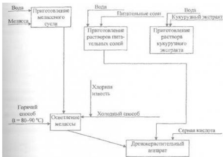
Рис.5. Технологическая схема приготовления питательной среды для выращивания хлебопекарных дрожжей
